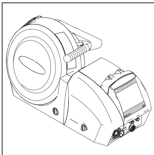
Sustavi za promjenu brzine žice WF15i, WF 25i, WF 30i opremljeni su pokrovom za kolut žice s vanjskim promjerom od maks. 300 mm (11,81 in.).
