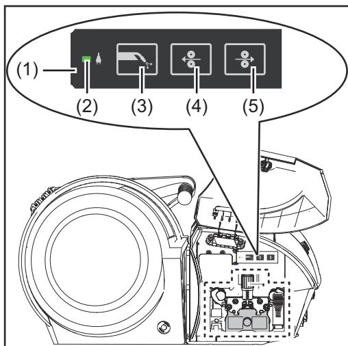
**Br. Funkcija****(1) OPT/i WF provjera plina i uvlačenje žice****(2) LED indikator za radno stanje**
