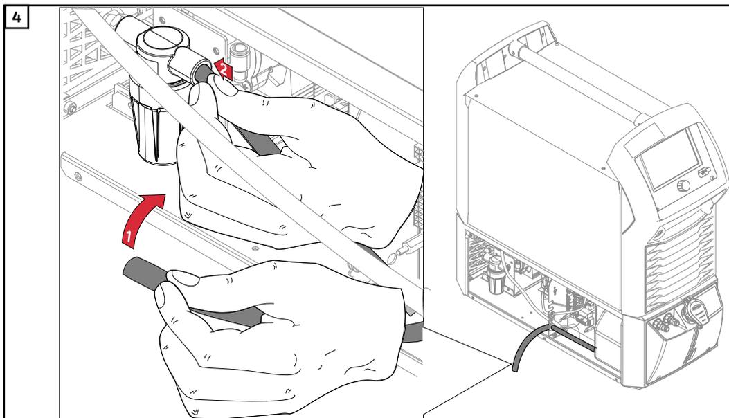
Kühlmittel-Schlauch in den Kühlmittel-Vorfilter stecken
